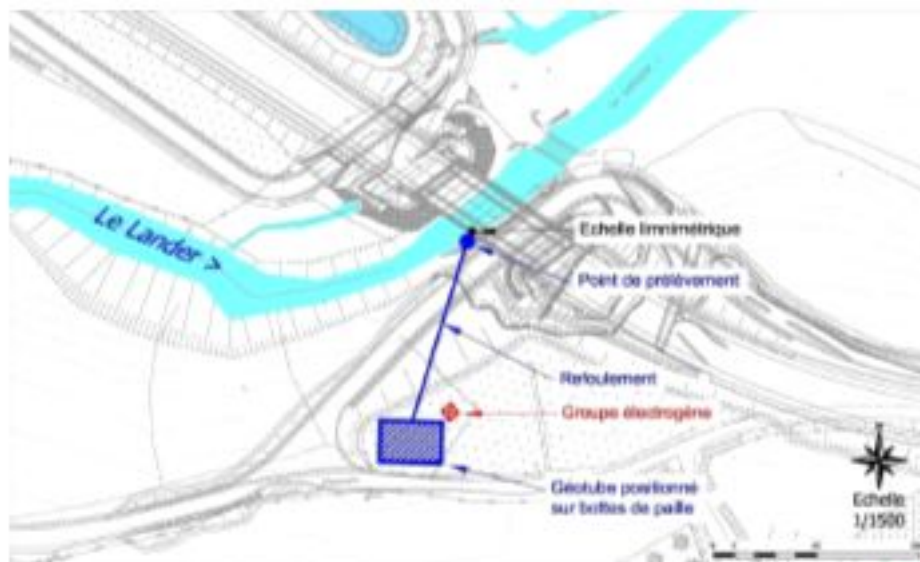
Principe des installations de pompage temporaire à Roffiac et au Rochain
