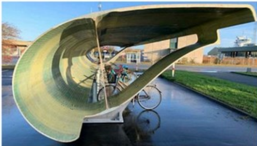
Figure 3: Parking à vélo conçu à partir d'un morceau de pale d'éolienne à Aalborg au Danemark, Source : www.revolution-energetique.com
