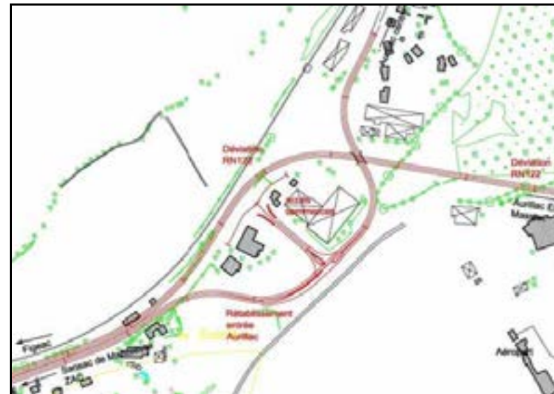
Solution de bas, constructions maintenues, accès rétablis par le sud
