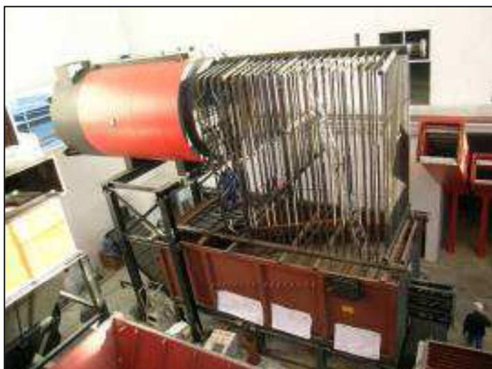
Dans l'échangeur, la chaleur des fumées est récupérée et transférée vers le réseau de chaleur. L'échangeur est équipé d'un système de ramonage pneumatique permettant le nettoyage des surfaces d'échange.
